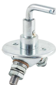
Coupe circuit 500A 24V - 100A (500A (5s)) • montage 23mm • épaisseur paroi 14mm max • cosse M10
